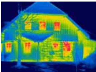
Die Außenthermografie zeigt das unauffällige Thermobild eines beheizten Hauses mit Holz-Verkleidung.
